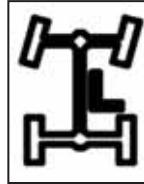
Индикатор режима полного привода H (высшая передача)
