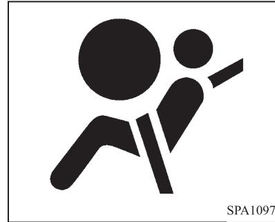
Предупреждающий световой сигнал системы подушки безопасности отражается на приборной панели в виде значка- . Он информирует о состоянии системы подушки безопасности и системы ремня ремня безопасности.
