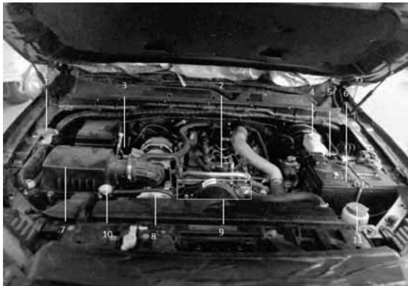
1. Бачок для жидкости омывателя лобового стекла
